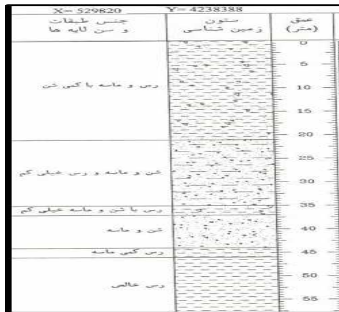
شکل (۷) لوگ حفاری مربوط به چاه مشاهده‌ای شهرستان تسوج (منطقه قلعه مراغوش)
