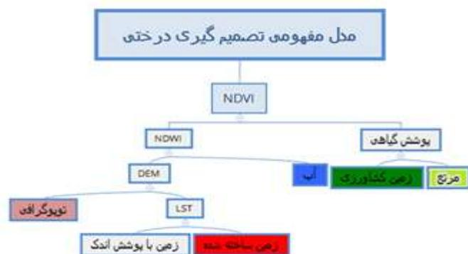
شکل (۲). روند تهیه نقشه کاربری زمین با استفاده از روش درخت تصمیم
