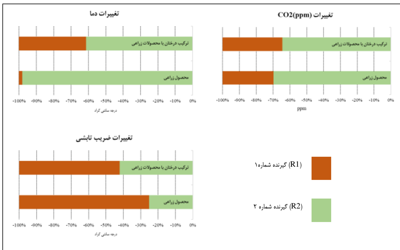
شکل ۹: تغییرات مقدار دما، ضریب تابشی و CO 2 در سناریوها، در مدت ۸ ساعت شبیه سازی در ارتفاع ۱/۸ متری (درگیرنده شماره ۲)
